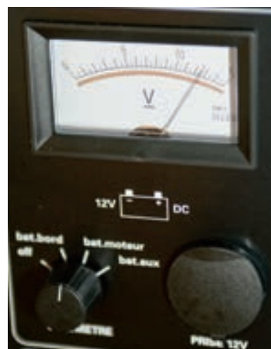
Odczyt około 12,5 V wskazuje, że bateria jest zdrowa i szczęśliwa.
