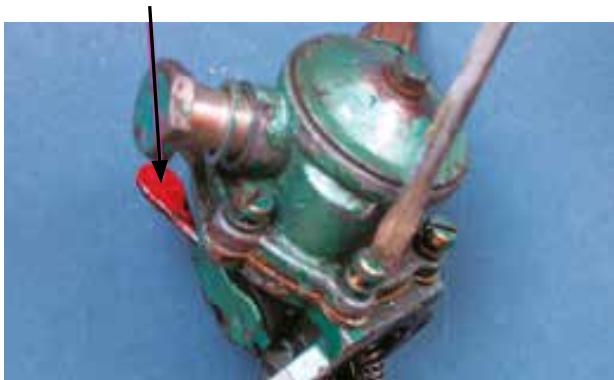
Łatwo dostępna dźwignia ręcznego napędu
