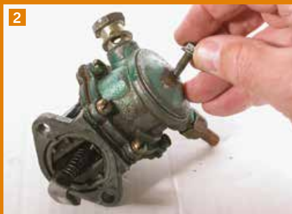
2 Użyj jej jako dźwigni do podważenia pokrywy.
