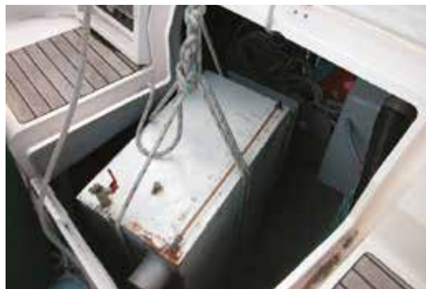
Kompletny zbiornik paliwa wyjmowany z jednostki rekreacyjnej; widoczne są wylot paliwa, osadnik z odpływem i szklany wziernik
