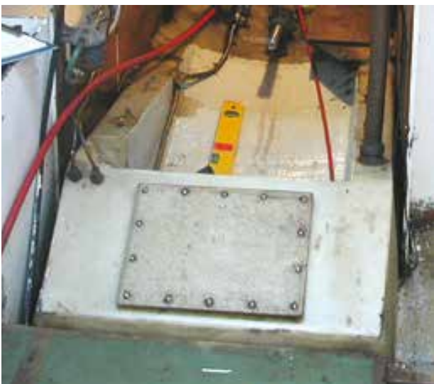
Zbiornik paliwa na statku z dobrze widocznym włazem inspekcyjnym; przewody paliwowe znajdują się w lewym górnym rogu zbiornika
