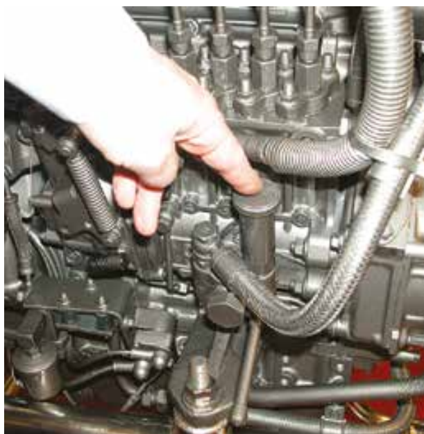
Pompa zasilająca typu tłokowego (palec wskazuje tłok)
