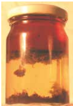
Mikroorganizmy rozrastające się między wodą i paliwem
