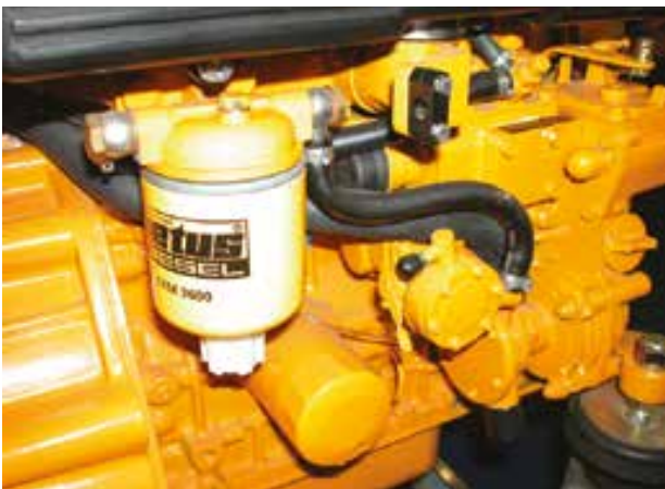
Filtr dokładnego oczyszczania zamontowany na silniku
