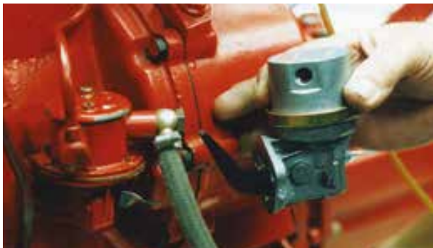
Pompa zasilająca nowego typu
