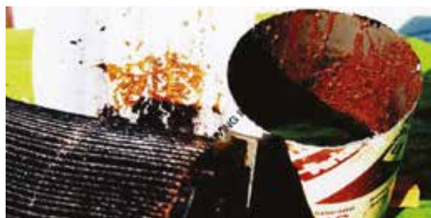
Poważny przypadek biozanieczyszczenia oleju napędowego
