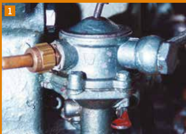
1 Włóż śrubę pod kątem w otwór w pokrywie.
