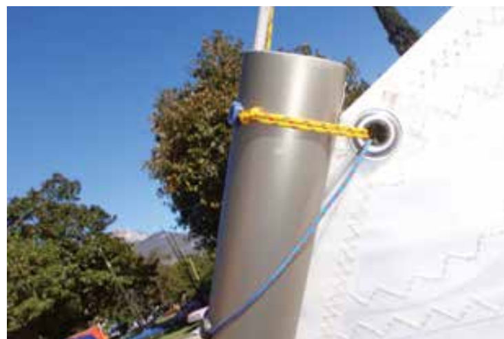
Krawat na rogu topowym. Warto zawiązać górny krawat podwójnie, nie można natomiast stosować jednocześnie drugiego górnego krawata
