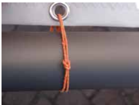
Krawat na bomie. Krawat przetarty nadaje się tylko do wymiany – nie żałuj „50 groszy” i nie czekaj, aż pęknie
