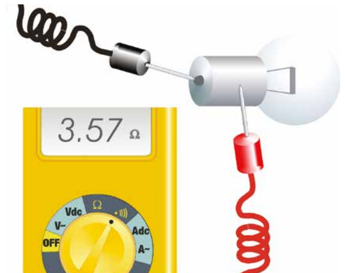
Sprawdzanie żarówki multimetrem
