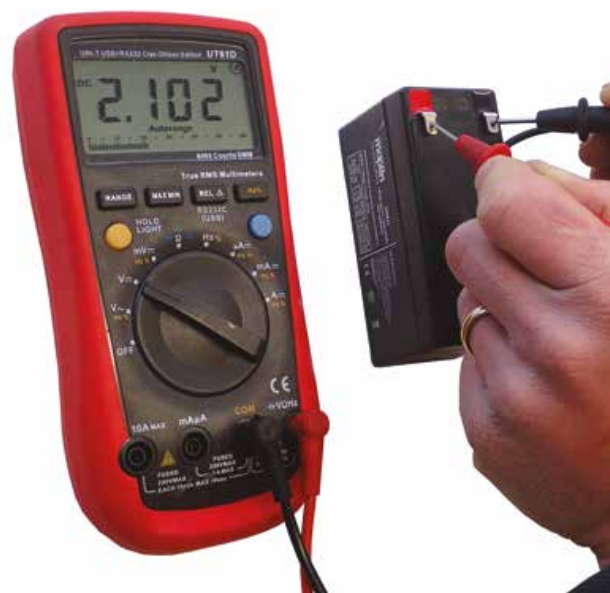
Pomiar napięcia multimetrem
