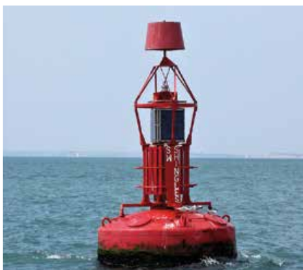
◀ Pełnowymiarowa pława oznaczająca granicę toru wodnego – wchodząc do portu, miń ją lewą burtą
