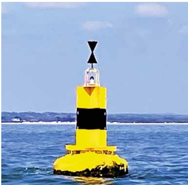
▲ Zachodni znak kardynalny, czarny pośrodku, zgodnie ze wskazaniem znaku szczytowego, żółty na górze i dole
